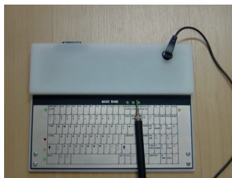
Foto 12 - Teclado de tamanho reduzido com acessório de uma caneta que pode ser utilizada para facilitar a digitação. O objetivo deste teclado é possibilitar aos alunos com diminuição na amplitude de movimento e pouca força muscular a realizar atividade no computador.
