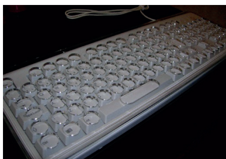
Foto 10 - Teclado coberto por uma colméia de acrílico transparente. A colméia é uma placa com furação coincidente às teclas e utilizada por alunos com problemas de coordenação motora. Esse recurso tem o objetivo de eliminar ou diminuir os erros de digitação.
