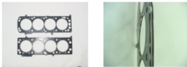
Figuras 15 e 16 – Juntas metálicas do cabeçote Fonte: Material de Motores Stilo FIAT
