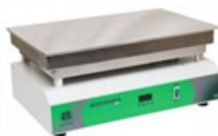
Chapa / Placa Aquecedora Microprocessada 30x50cm SXCM 5.3-2 Sterilifer
