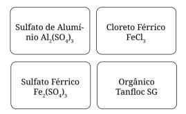
A coagulação mediante mecanismos de desestabilização, conforme mencionado, desorganiza o sistema (antes estável) o qual mantém as partículas que conferem cor e turbidez à água afastadas umas das outras. Durante esse processo, os coagulantes, os quais apresentam carga positiva, são atraídos pelas partículas coloidais, que possuem carga elétrica negativa na sua estrutura. A coagulação por desestabilização é, portanto, um fenômeno químico.
