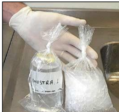
6- Coloque o saco de coleta em saco plástico e acondicione em embalagem isotérmica com gelo.
