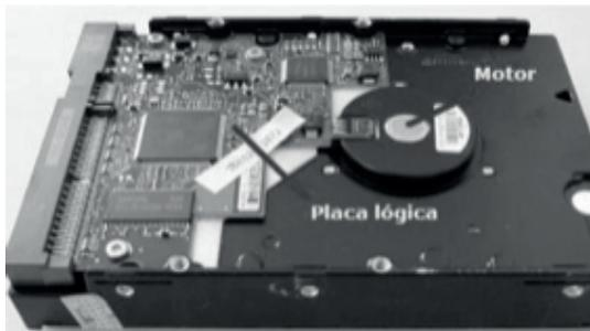
HD indicando a placa lógica e o motor
