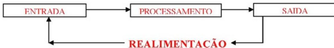
Figura 1: Etapas de um processamento de dados.
