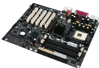
É uma das partes mais importantes do computador. A motherboard é uma placa de circuitos integrados que serve de suporte para todas as partes do computador.
