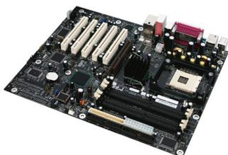
É uma das partes mais importantes do computador. A motherboard é uma placa de circuitos integrados que serve de suporte para todas as partes do computador.
